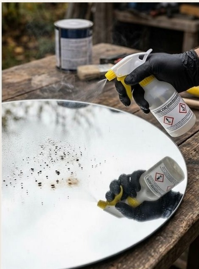
FIG. 02 Vaporisation d'acide en fines gouttelettes sur l'argenteure nue.
