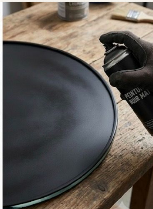
FIG. 03 Application de la peinture noir mat en bombe sur l'arrière décapé et patiné.
