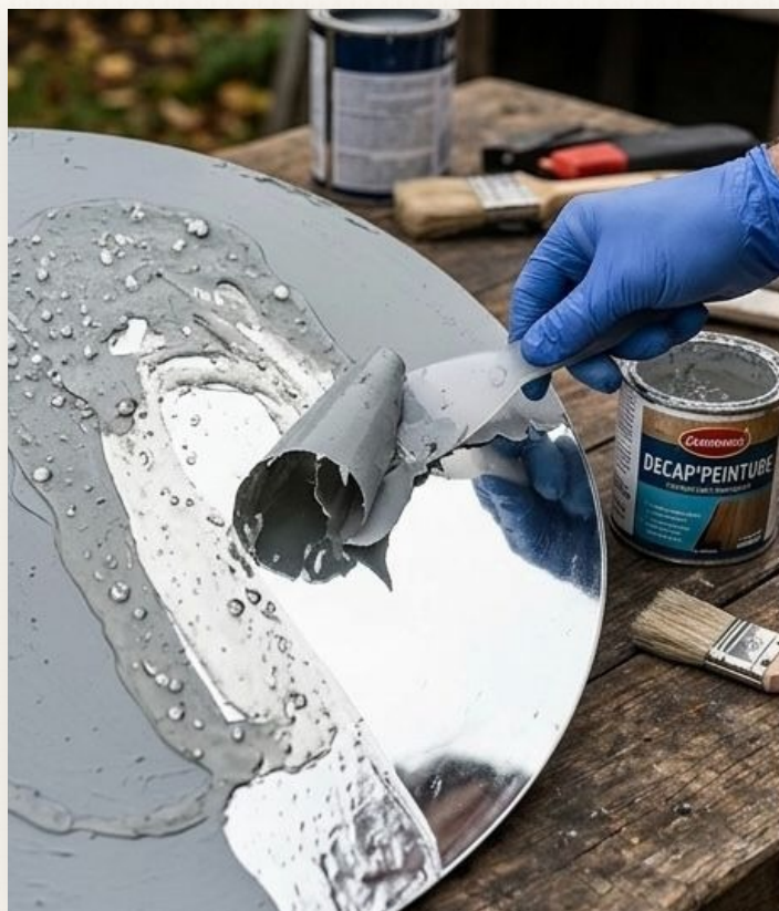
FIG. 01 Décapage à la spatule sur miroir posé face contre l'établi.
